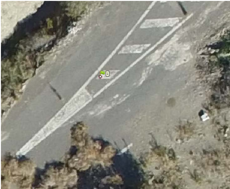
Ilustración 26 Posición de un marcador sobre un punto de apoyo
