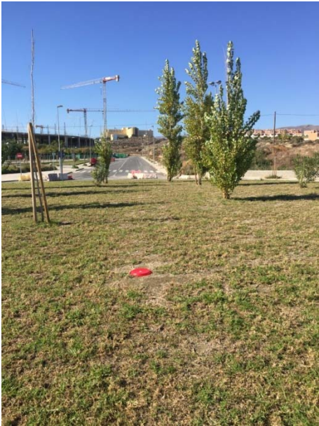
Ilustración 23 Punto de apoyo situado en campo antes del vuelo
