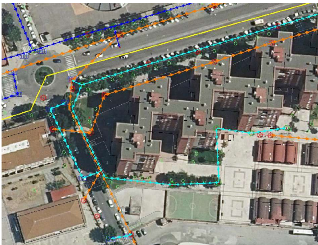
Vista de los tramos de pluviales conectados a fecales en la avenida del Ejército.
