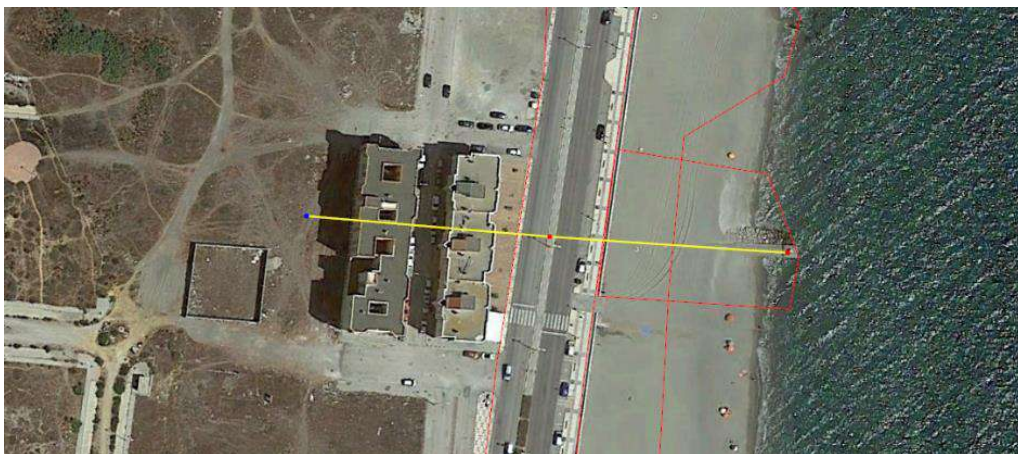
Colector de pluviales Ø1000 mm.
