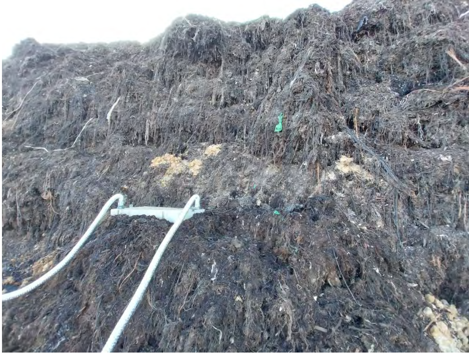
Fotografía V.3: Toma de muestras, con el método del túnel de viento, en la zona de biodegradación antigua.
