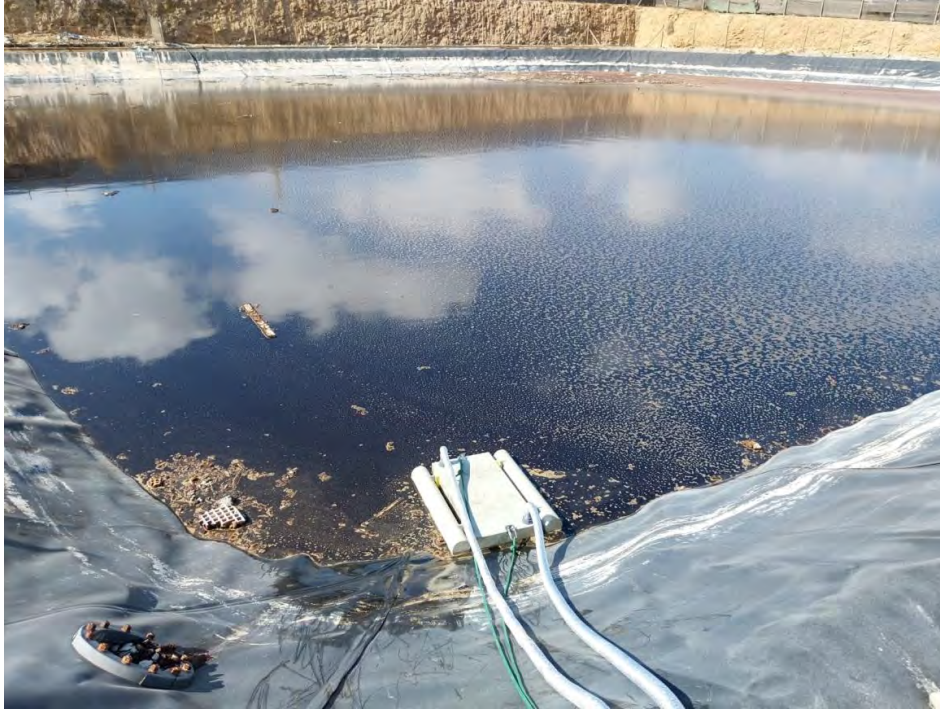
Fotografía V.9: Toma de muestras, con el método del túnel de viento, en la balsa de lixiviados.
