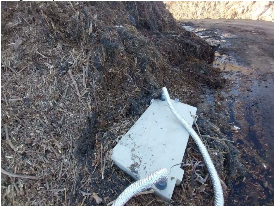
Fotografía V.2. Toma de muestras, con el método del túnel de viento, en la zona de biodegradación intermedia.
