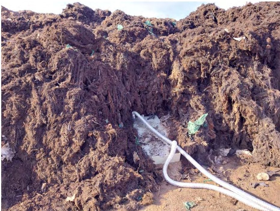
Fotografía V.6: Toma de muestras, con el método del túnel de viento, en la zona de rechazo.
