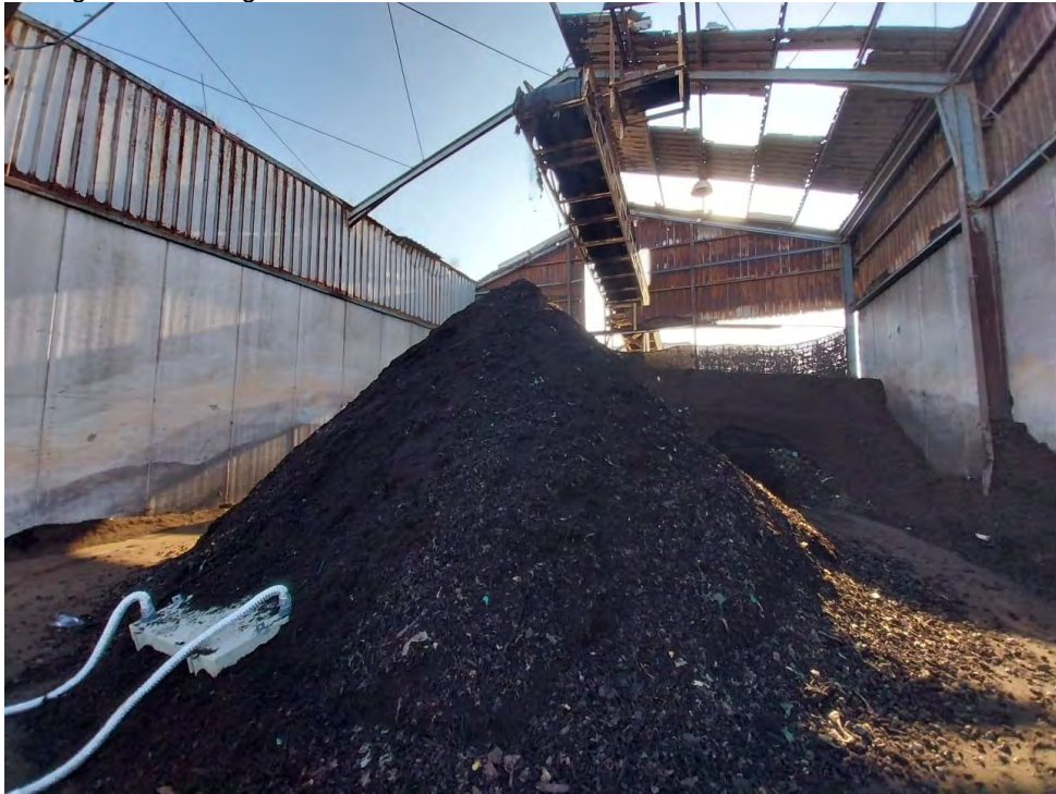
Fotografía V.4: Toma de muestras, con el método del túnel de viento, en la zona de acopio de afino.
