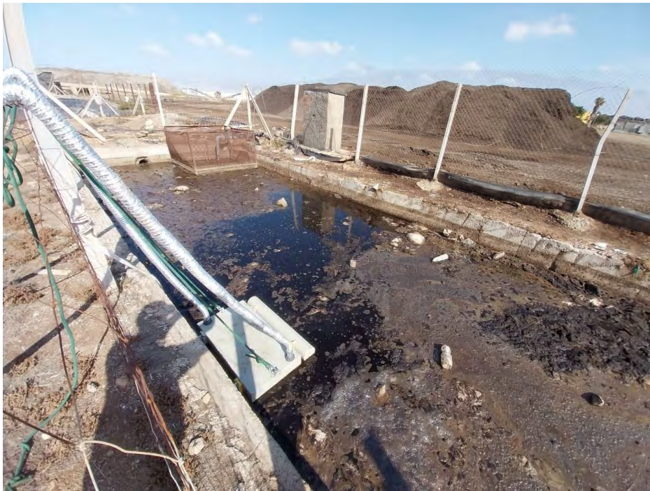
Fotografía V.8: Toma de muestras, con el método del túnel de viento, en la balsa de decantación del lixiviado.
