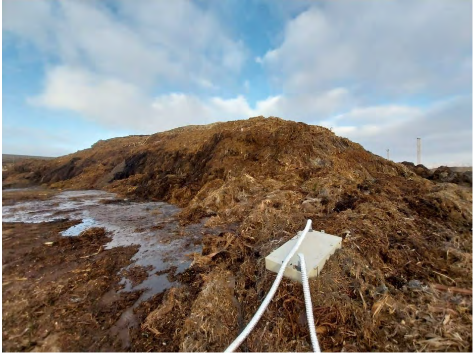
Fotografía V.1. Toma de muestras, con el método del túnel de viento, en la zona de biodegradación joven.
