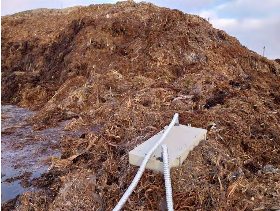
Fotografía V.7: Toma de muestras, con el método del túnel de viento, en una de las 2 muestras tomadas en la zona de maduración.
