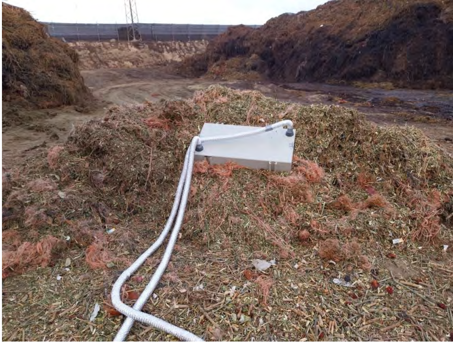
Fotografía V.5: Toma de muestras, con el método de la sonda, en la zona de triturado.
