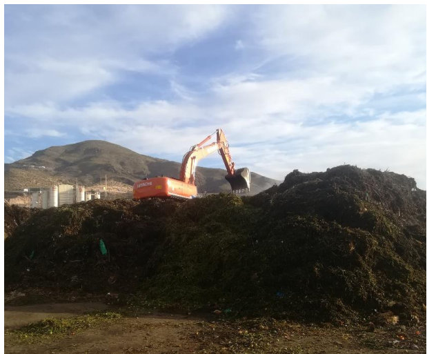
Retroexcavadora volteando una pila en planta
