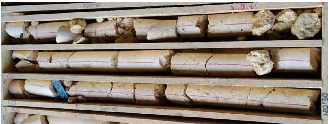
*Figura 10. Ejemplo de indicación de un testigo para su corte*
