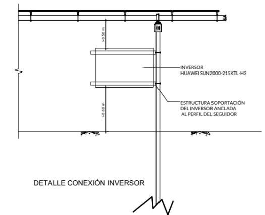
DETALLE CONEXIÓN INVERSOR
