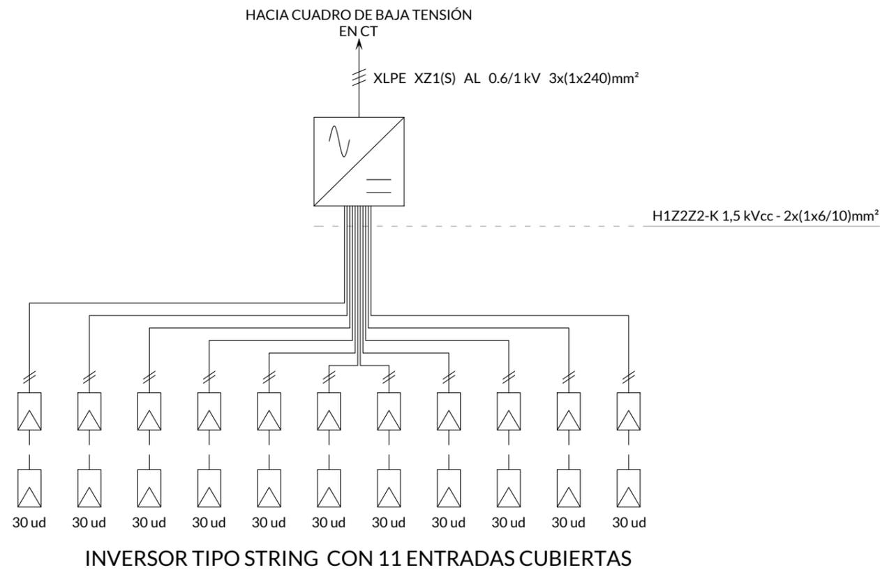
INVERSOR TIPO STRING CON 11 ENTRADAS CUBIERTAS
