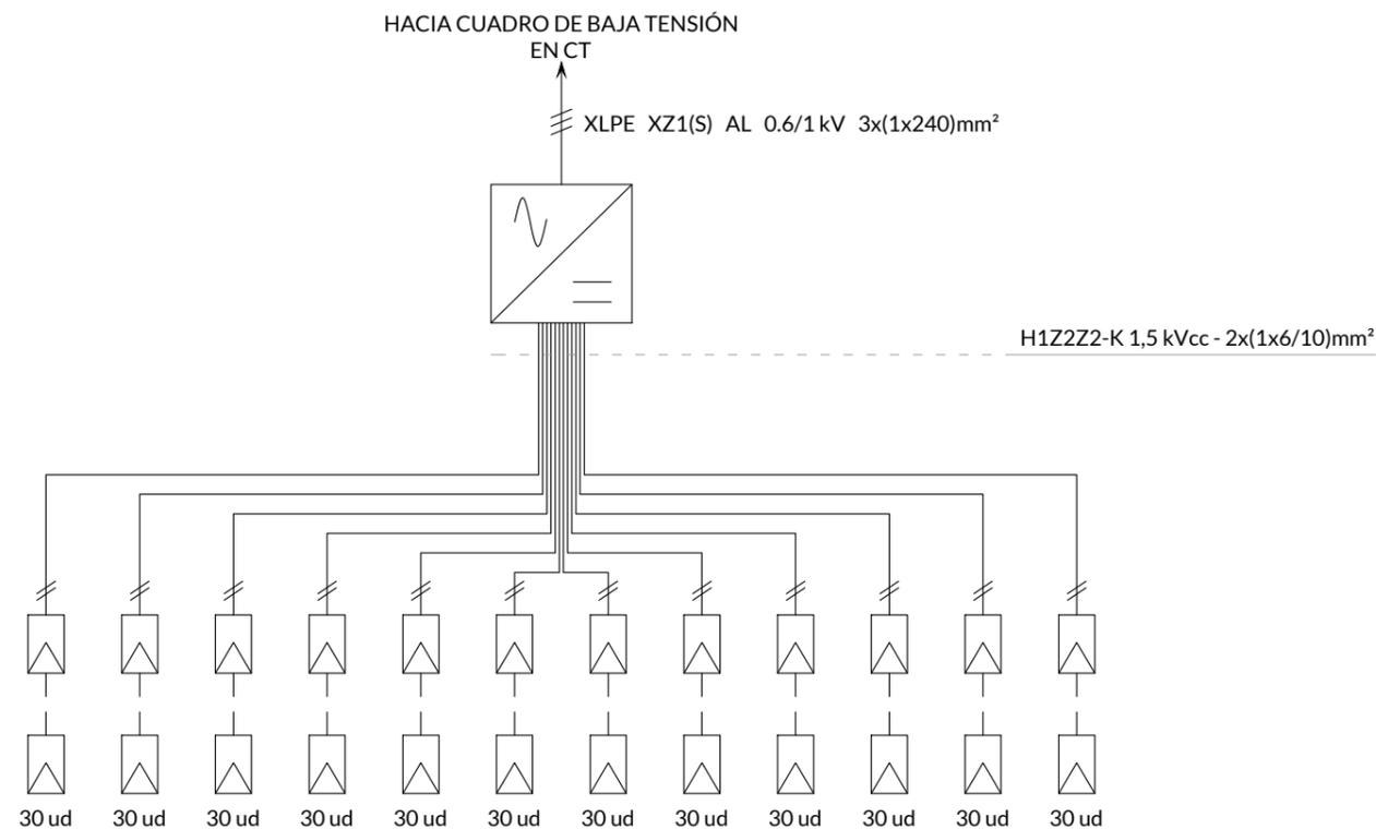
INVERSOR TIPO STRING CON 12 ENTRADAS CUBIERTAS
