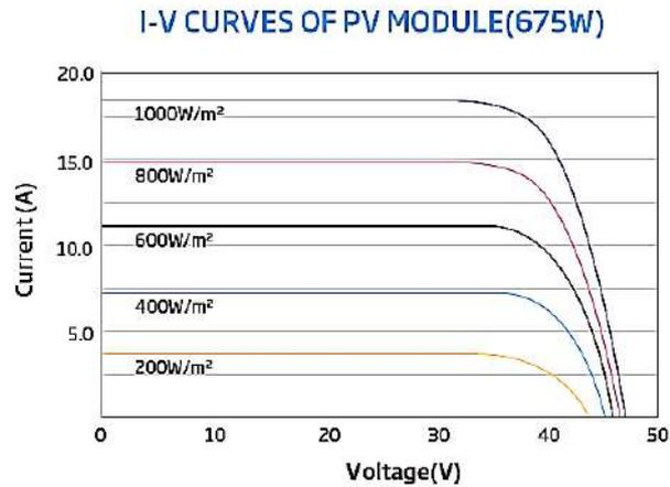
Se puede observar que se presentan diferentes curvas de comportamiento en función de la radiación y la temperatura, esto se debe a que el rendimiento de los paneles disminuye cuando aumenta su temperatura. Dicho factor se tendrá en cuenta en el cálculo energético, a la hora de estimar la producción anual de la planta.
