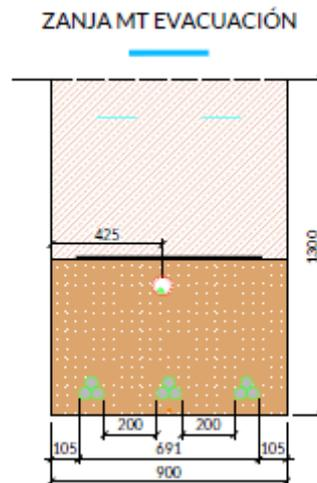
Figura 1: Zanja tipo MT más desfavorable, con tres circuitos de MT, correspondiente a la línea de media de evacuación.
