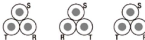
**Figura 7. Colocación de cables en tresbolillo.**
