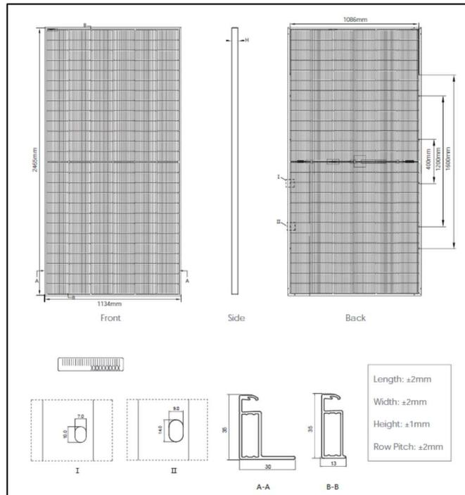
**Figura 4. Esquema y medidas del módulo fotovoltaico.**
