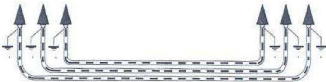
*Figura 29: Puesta a tierra de cubiertas metálicas.*
