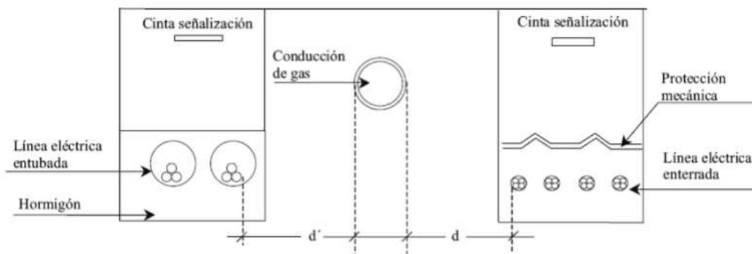
**Figura 33: Detalles de paralelismo y conducciones (ITC-LAT 06).**
