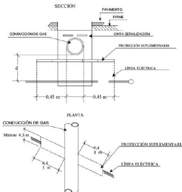
**Figura 31: Detalles de cruzamiento y conducciones (ITC-LAT 06).**
