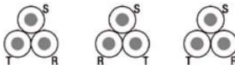
**Figura 28: Colocación de cables en tresbolillo.**
