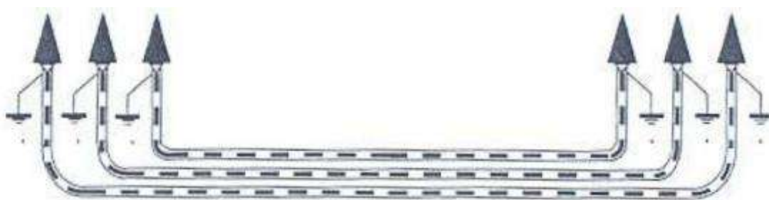
Figura 29: Puesta a tierra de cubiertas metálicas.
