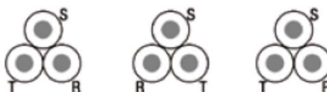
**Figura 29: Colocación de cables en tresbolillo.**
