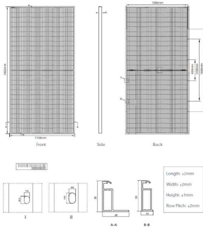
**Figura 25: Dimensiones del Módulo.**
