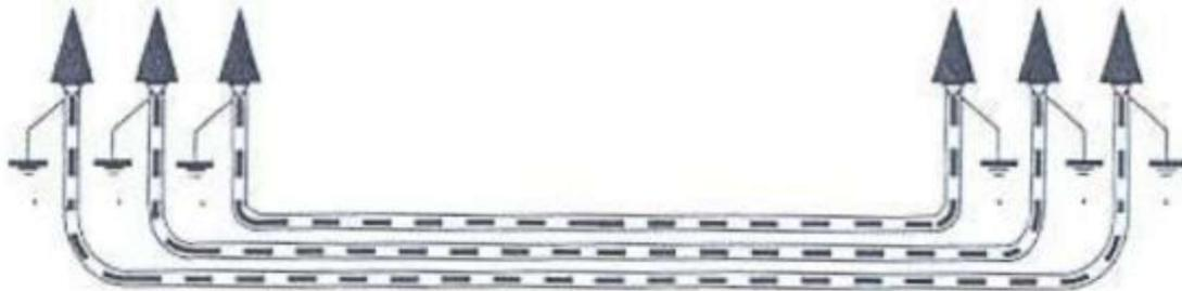
*Figura 30: Puesta a tierra de cubiertas metálicas.*
