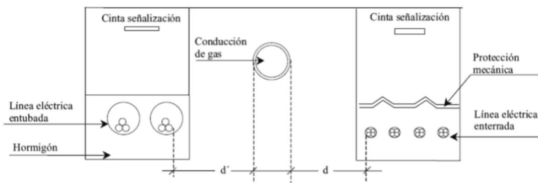
**Figura 34: Detalles de paralelismo y conducciones (ITC-LAT 06).**
