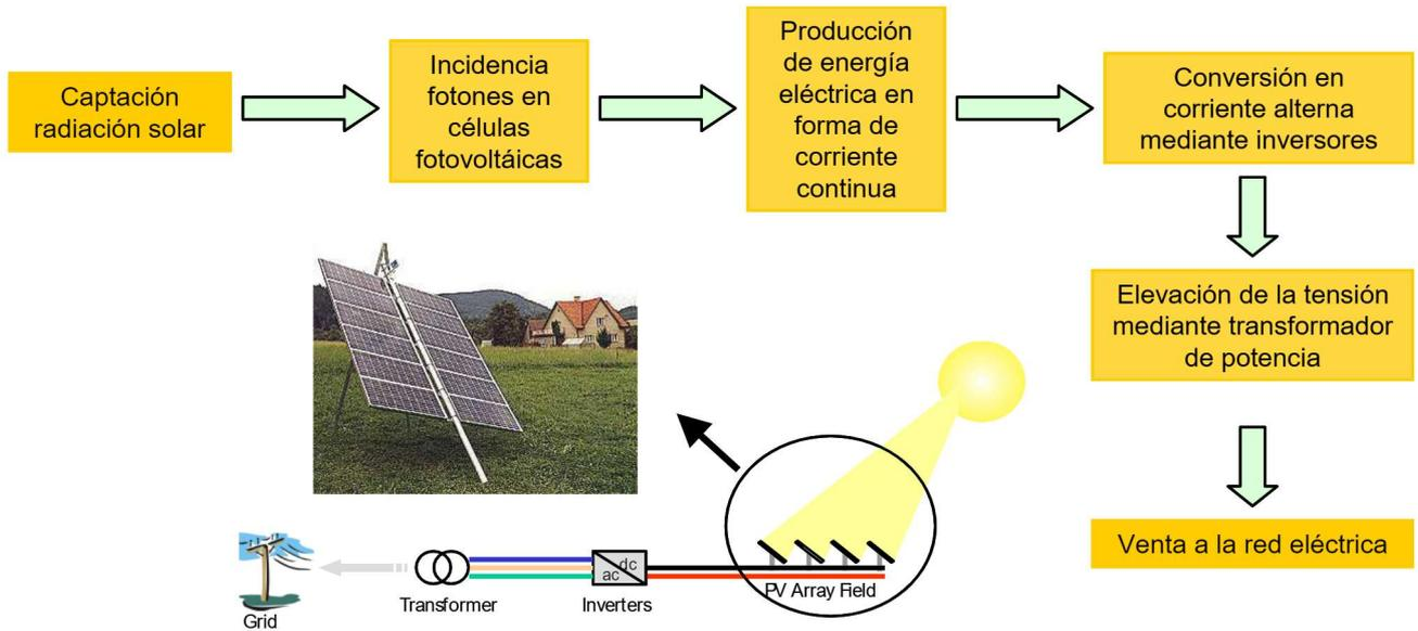
**Figura 23: Principio de Funcionamiento Instalación FV.**
