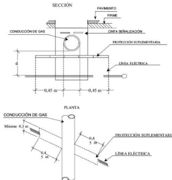
**Figura 32: Detalles de cruzamiento y conducciones (ITC-LAT 06).**
