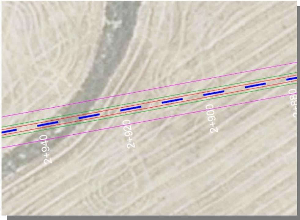
Fig. 1 Imagen en planta de la línea eléctrica soterrada, en la que se pueden apreciar la canalización (líneas rojas con línea discontinua azul en su interior), el área afectada por servidumbre de paso subterráneo de energía eléctrica (lo comprendido entre las líneas verdes), y, finalmente, la ocupación temporal para las obras, definida como la comprendida entre las líneas de color rosado.
