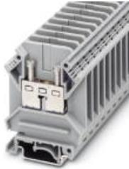
Borne de paso, Tipo de conexión: Conexión por tornillo, Sección: 0,5 mm<sup>2</sup> - 10 mm<sup>2</sup>, AWG: 20 - 8, Anchura: 10,2 mm, Color: gris, Tipo de montaje: NS 35/7,5, NS 35/15, NS 32
