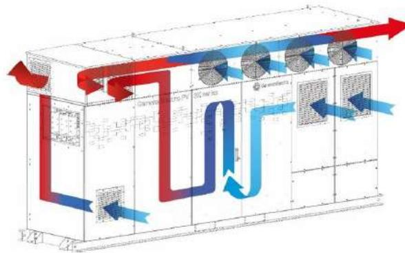
Ilustración 8: Flujos de aire en el PV 2X Gamesa Electric
