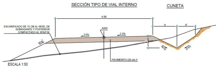
Ilustración 18: Sección tipo de vial interno.
