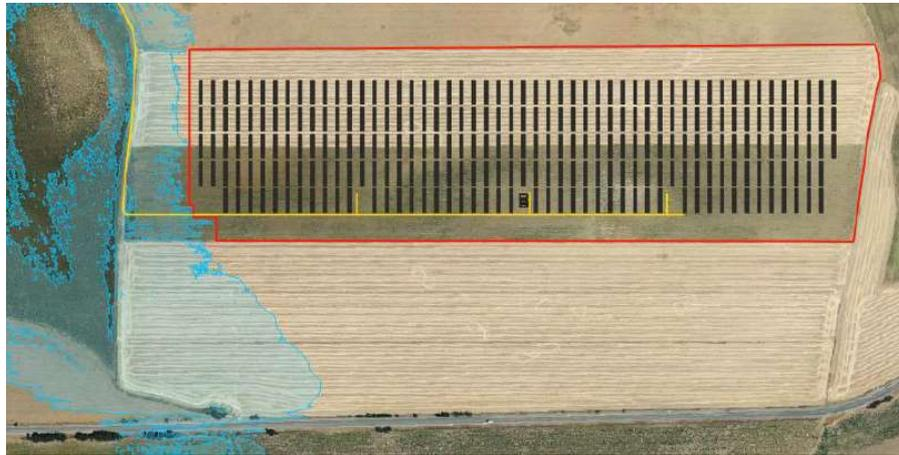
Los paneles fotovoltaicos se situarán en la Zona Inundable, quedando encima del calado del agua en ese punto, y fuera de la Zona de Flujo Preferente. El cerramiento perimetral será permeable, permitiendo el paso de las avenidas.
