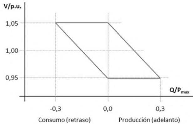
Ilustración 13: Diagrama U-Q/P de un módulo de generación de electricidad síncrono tipo B cuando  $P_{max} < 15 \text{ MW}$ .
