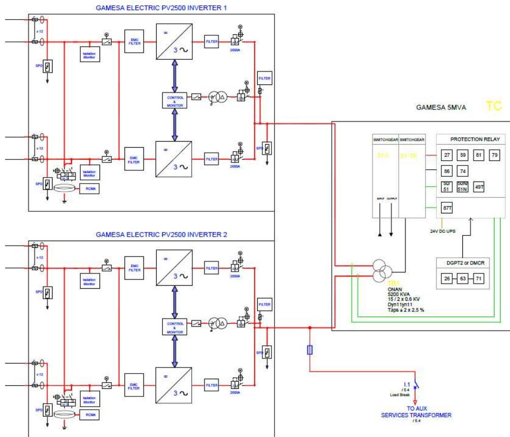
Ilustración 11: Esquema unifilar de un PV Station con la conexión con los inversores
