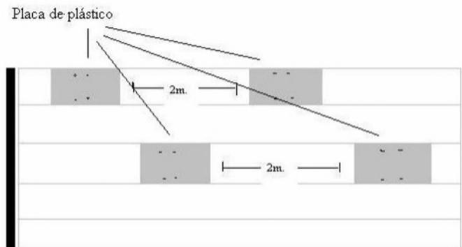
Ilustración 19: Croquis Vallado con placas de señalización anticollisión de la avifauna.
