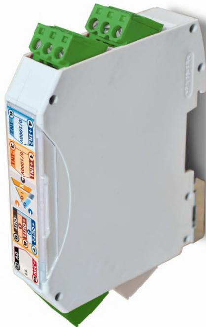
Los aisladores de 1 Y 2 canales independientes de señales 0/1500VDC a 4/20mA (activa), separan galvánicamente circuitos de medición. Están protegidos en sus entradas y salidas contra sobrecorrientes y sobretensiones por protectores rearmables.
