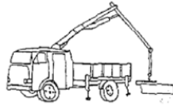
Levante de tubos con enganche en forma de horquilla
