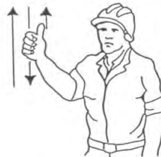
4 Levantar el aguilón o pluma lentamente
