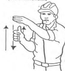
4 Levantar el aguilón o pluma lentamente
