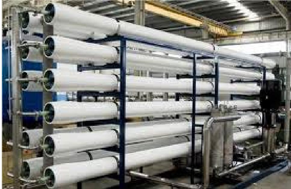
Ilustración 4-27: Instalación de ósmosis inversa.
