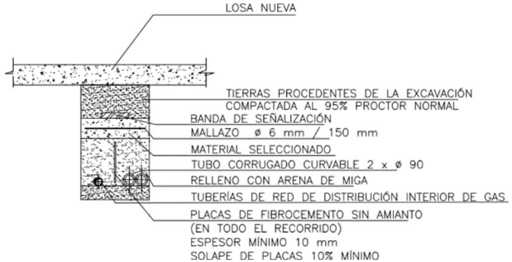
Figura 3-2. Enterramiento de la tubería.
