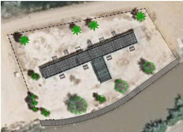
Se distinguen varios elementos: una construcción de madera de unos 60 ml de longitud, formada por hincas de rollizos en el borde del canal, tornapuntas estructurales para dar resistencia al elemento y tablazón que permiten abrir una silla sobre una superficie horizontal y tirar los aparejos de pesca; una pérgola
