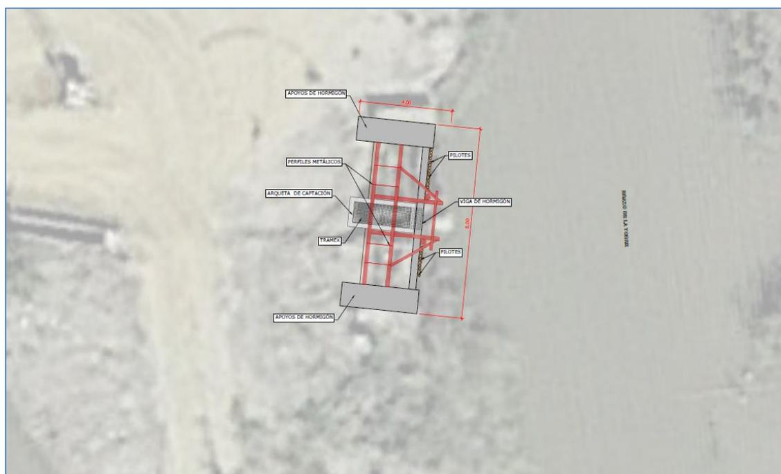
La captación en la toma se compone de una obra civil en el margen derecho del canal Brazo de La Torre, el cual se distribuye por su gravedad hacia la captación y desde ésta se distribuye hacia la red de riego mediante un grupo motor-bomba móvil que distribuye el agua hacia las canaletas de hormigón que forman la red de riego.
