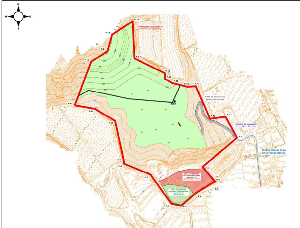
Figura 11. Situación de áreas de extracción de tierra vegetal al sur del ámbito.
