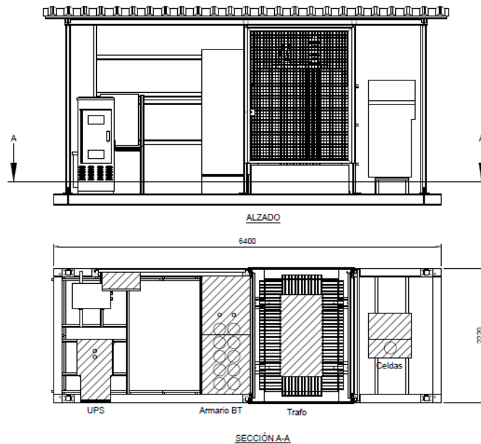
Figura 7. Detalle de estructura del centro de transformación
