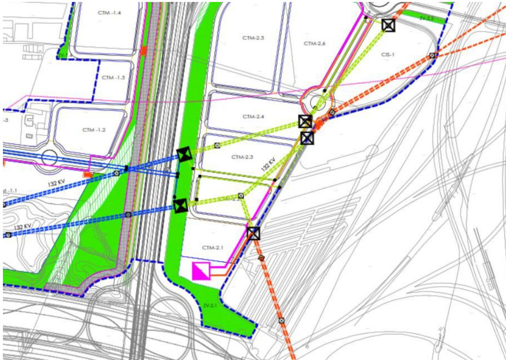
Trazado actual de las líneas de 132kV
