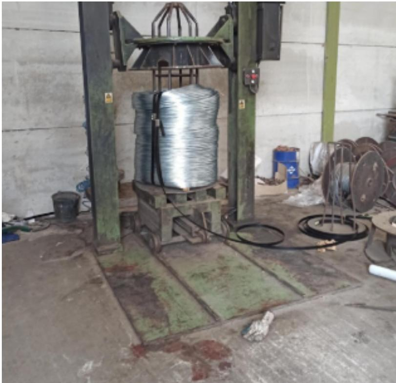
Máquina compactadora. El trabajador quedó atrapado entre la parte móvil y la bobina.
