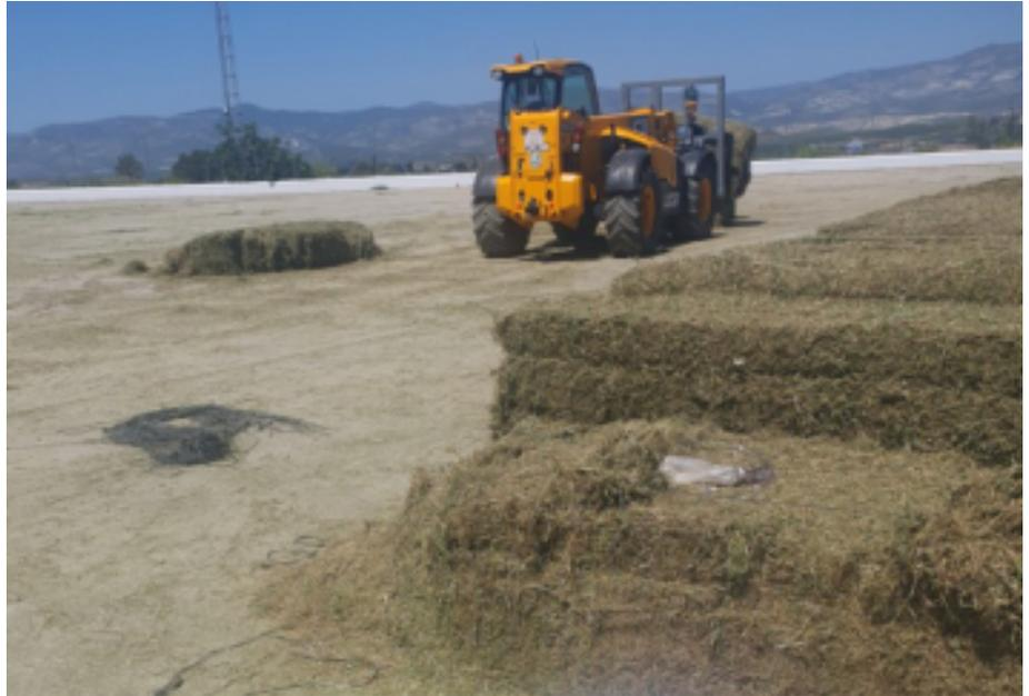
Explanada de secado de alfalfa, donde un trabajador fue atropellado por un manipulador telescópico mientras cortaba cuerdas, sin ser visto por el operador.
