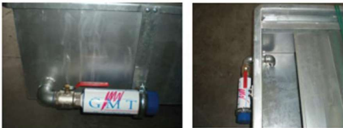
Figura 4. Detalle del cubeto de retención y del cartucho de filtración.
