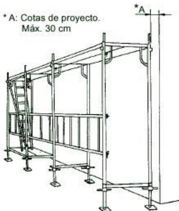
Una vez montado el primer cuerpo del andamio se debe verificar con un nivel de burbuja la nivelación vertical y horizontal, rectificando desniveles mediante los husillos.
