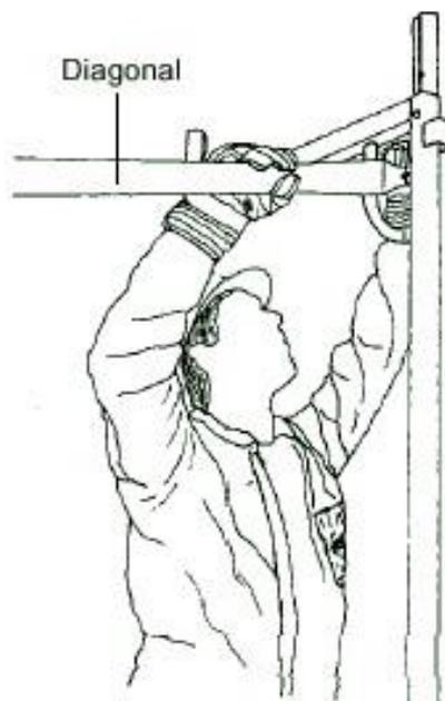
Colocar los arriostramientos horizontales diagonales para mantener la verticalidad del andamio.
