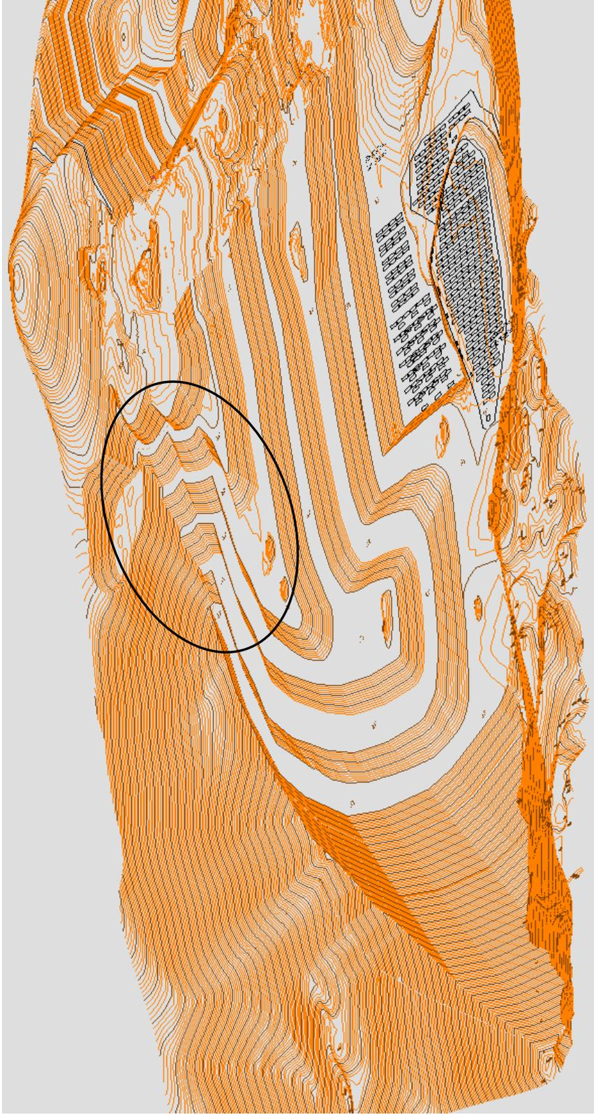
Figura 129. PROPUESTA ESTADO FINAL ESCOMBRERA POZO UNIFICANDO ESCOMBRERA REVERTE
