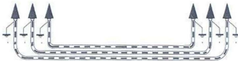
Fig. 18 Puesta a tierra cubiertas metálicas
