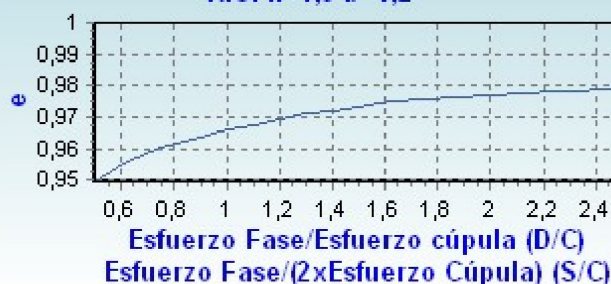
Esfuerzo horizontal que soportan los apoyos con cúpula R.U. h=1,5 b=1,2
