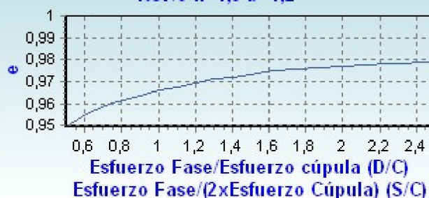
Esfuerzo horizontal que soportan los apoyos con cúpula RU7/9 h=1,5 b=1,2
