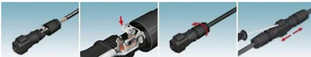
El conector hembra y conector macho pueden ser fácilmente conectados juntos de forma manual. Un bloqueo integrado que sólo se puede aflojar con un destornillador impide el aflojamiento accidental de la DC plug-in de conexión cuando se somete a cargas.
