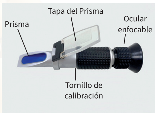
Figura 13. Refractómetro manual y sus partes
