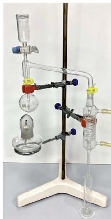
Figura 27. Montaje Mathieu para determinación de acidez volátil
