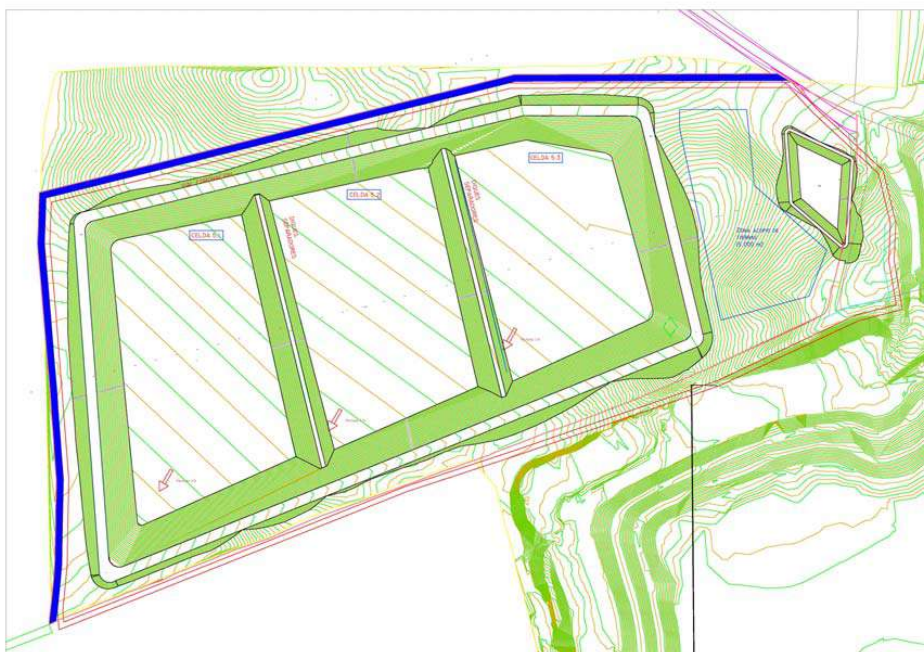
Figura 2. – Planta constructiva de la celda. Fases de excavación. Balsa de lixiviados. Fuente AZCATEC
