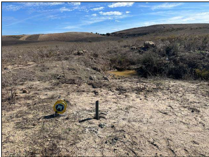
Fotografía 6.- Medición con sonda piezométrica de sondeos geotécnicos: S-5.
