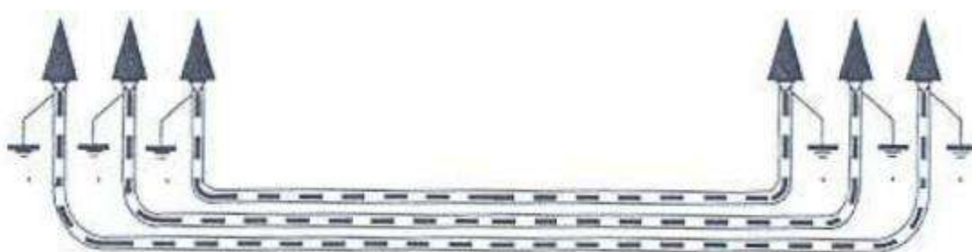
Figura 25: Puesta a tierra de cubiertas metálicas.
