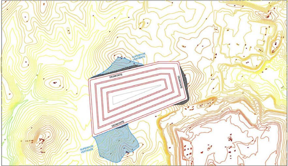
Imagen nº55 – Superficies vertientes para los taludes de desmonte.
