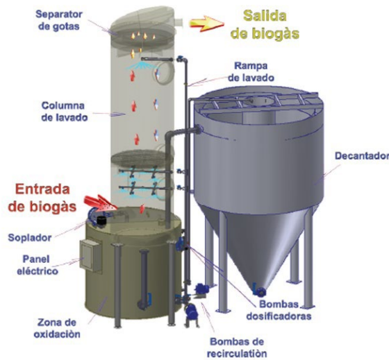
Ilustración 4-188. Instalación de desulfuración (Fuente: Virtus)
