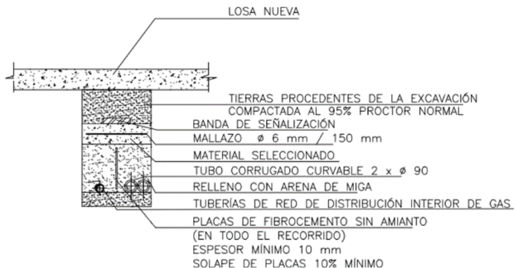
Figura 4-23. Enterramiento de la tubería.
