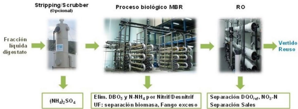
Figura. 4-4 Configuración típica de un sistema de tratamiento de la fracción líquida mediante el enfoque de eliminación. Fuente: Wehrle.
