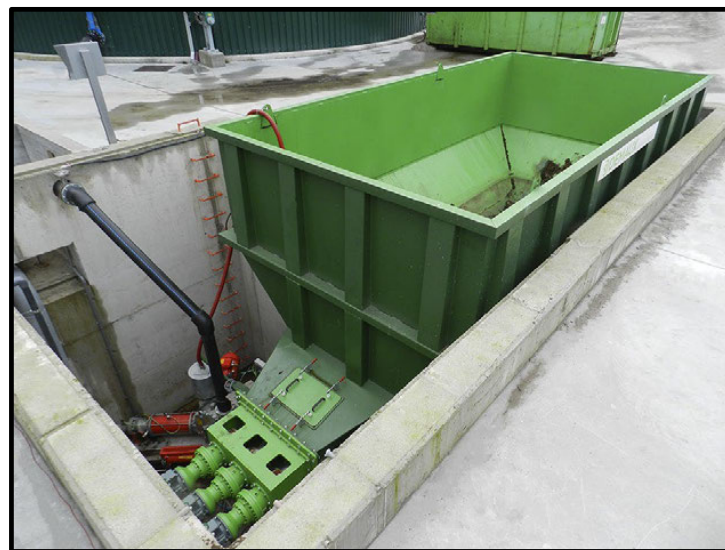
Figura 4-3. Tolva de recepción con tornillos de extracción.
