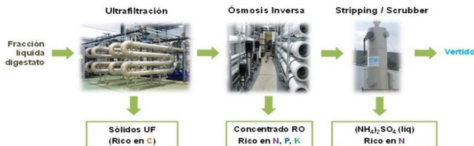
Figura. 4-3 Configuración típica de un sistema de tratamiento de fracción líquida de digestatos mediante el enfoque de recuperación.
