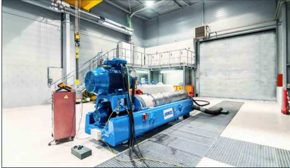
Figura 4-26. Sistema de centrífuga de separación sólido-líquido.
