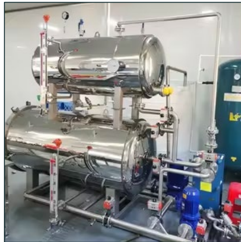
Figura 4-8. Pasteurizador industrial.
