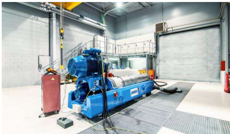
Sistema de separación sólido-líquido
