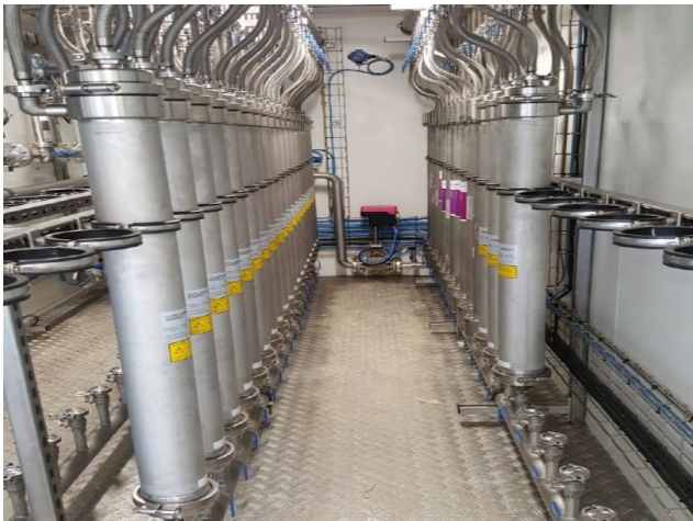
Figura 6-21. Upgrading de biogás por membranas.
