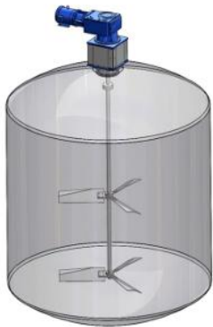
Figura 12. Sistema de agitación CSTR.
