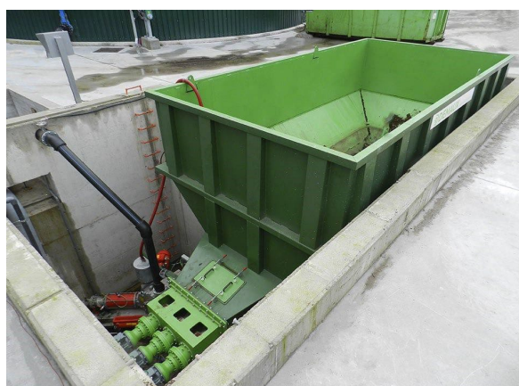
Figura 6-2. Tolva de recepción con tornillos de extracción.
