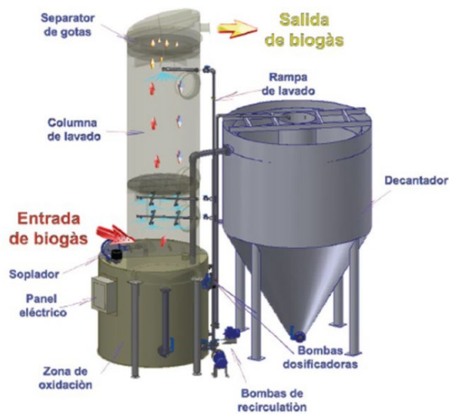
Figura 6-17. Desulfuración química con recuperación de reactivo.
