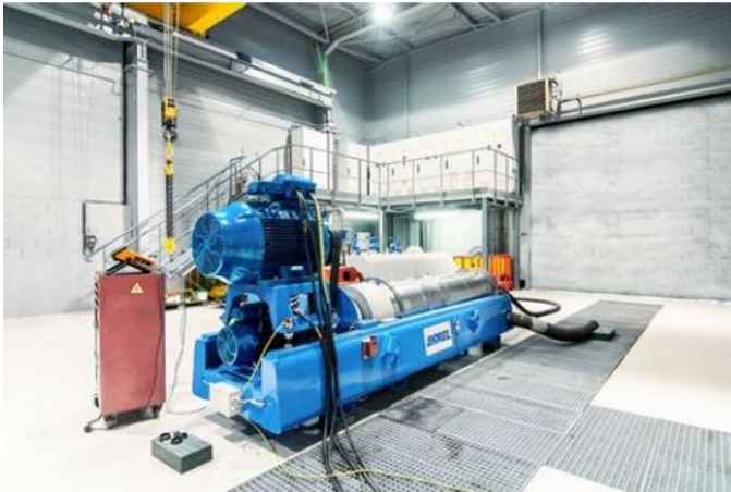
Figura 26. Sistema de centrifuga de separación sólido-líquido.
