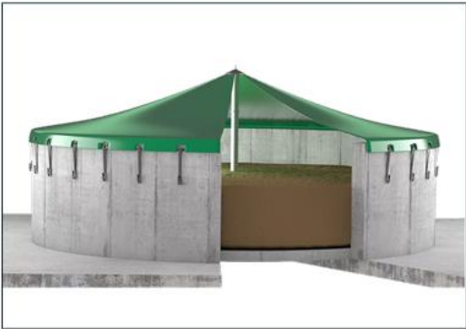
Figura 28. Tanque de hormigón de almacenamiento de digestato.
