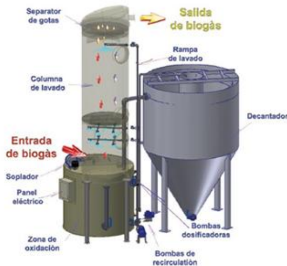
Figura 18. Instalación de desulfuración.
