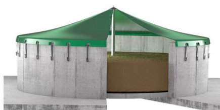
Figura 6-27. Tanque de hormigón de almacenamiento de digestato.
