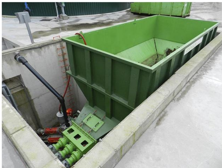
Figura 4. Tolva de recepción con tornillos de extracción.
