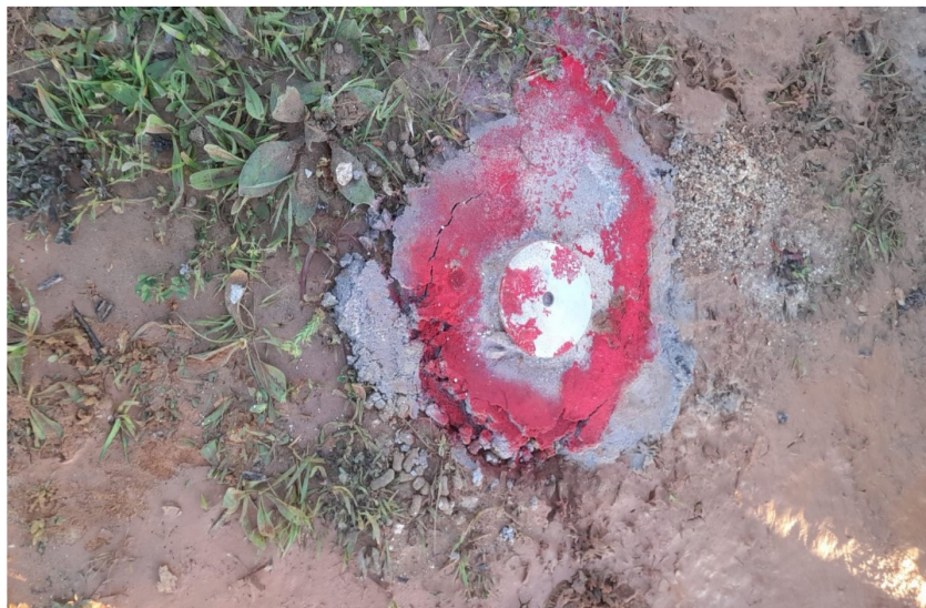
Instalación piezómetro P1.
