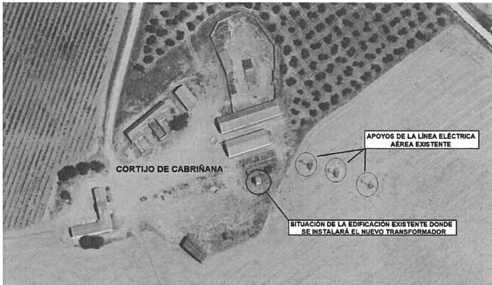
Fot. 3.- Imagen en la que se aprecian los apoyos de la línea eléctrica aérea de alta/media tensión existentes y la edificación que albergará el nuevo transformador requerido para alimentar los motores y bombas de la ampliación del riego.
