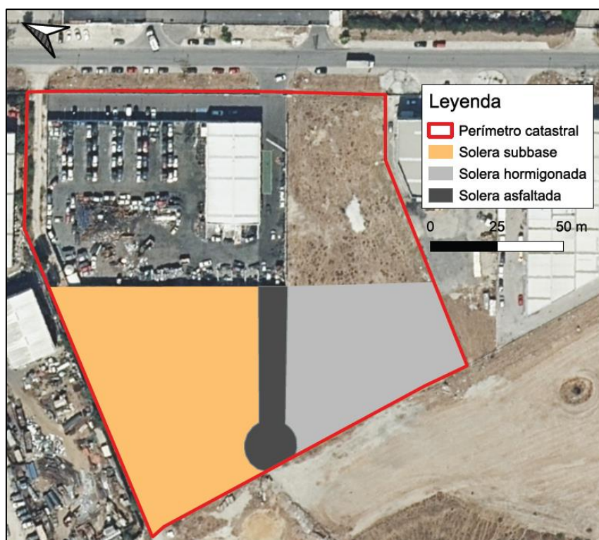
Figura 5. Detalle del estado final de las soleras. Fuente: Elaboración propia.
