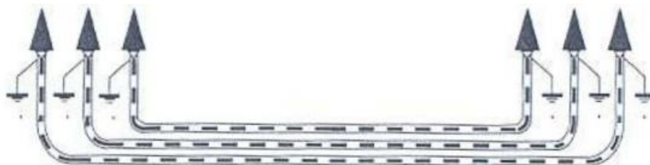
Figura 25: Puesta a tierra de cubiertas metálicas.
