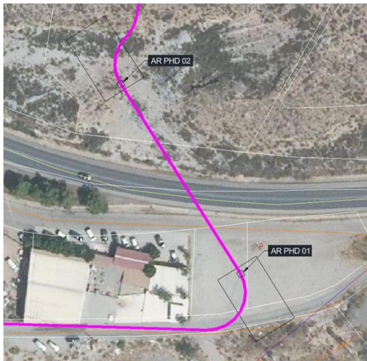
Ilustración 12. Situación Perforación Horizontal Dirigida
