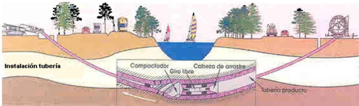
Ilustración 11. Esquema del proceso de instalación de la tubería
