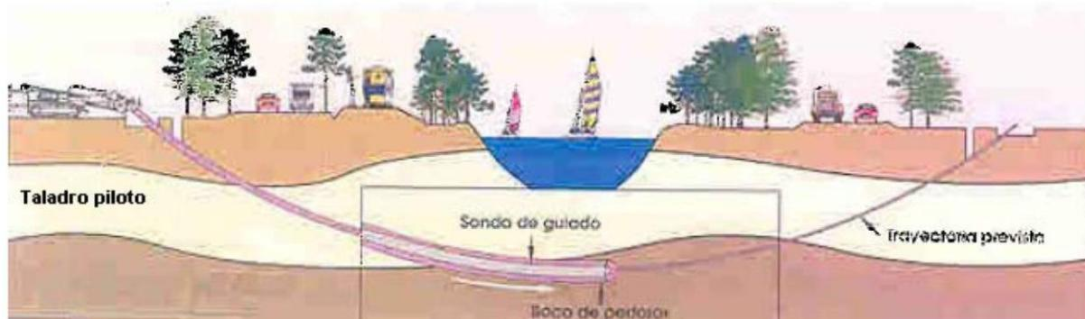
Ilustración 9. Esquema del proceso de la perforación piloto
