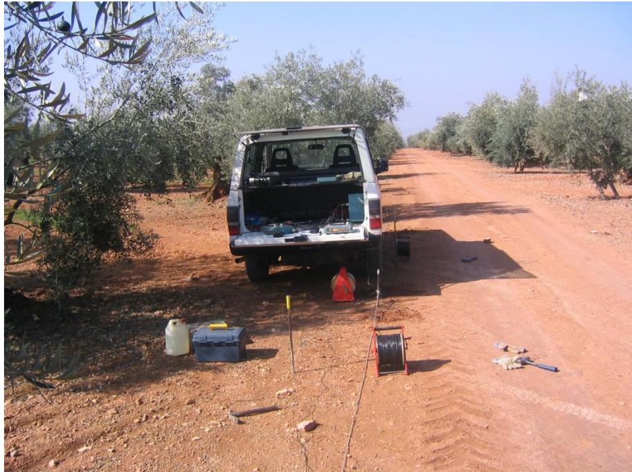
Fotografía 1. Equipo para realización de Sondeos Eléctricos Verticales Geotron
