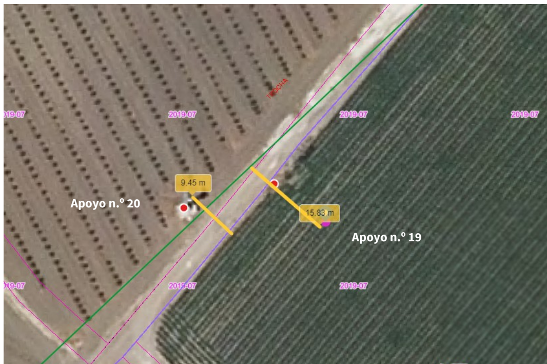
Imagen 1: En verde traza aproximada de la vía pecuaria. En rosa nuevo apoyo n.º 19. En rojo apoyos iniciales.
