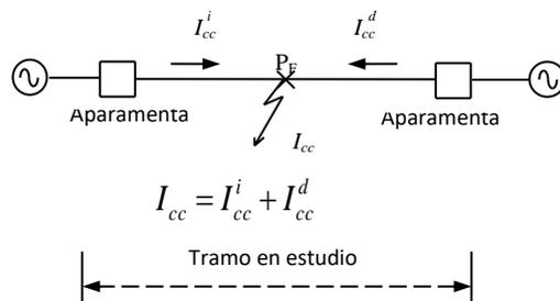
Para dimensionar los conductores y apartamento del tramo en estudio, se debe seleccionar la mayor de  $I_{cc}^i$  y  $I_{cc}^d$ , que es la correspondiente al lado con menor impedancia, por ser el lado que aportará más intensidad en caso de falta.
