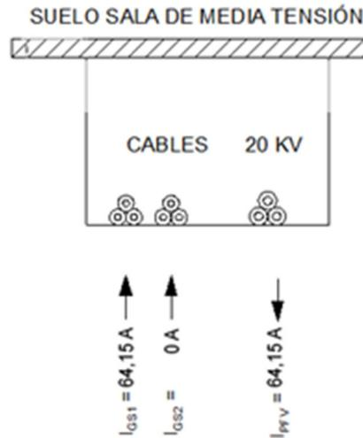
En el esquema anterior se representa la intensidad total que discurre por cada circuito trifásico. El sentido de circulación de la intensidad en cada una de las líneas trifásicas hará que los campos magnéticos producidos por las líneas de entrada se contrarresten con el de las líneas de salida.
