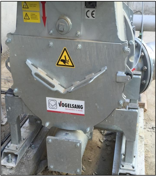
Ilustración 18. Dilacerador residuos sólidos SANDACH.
