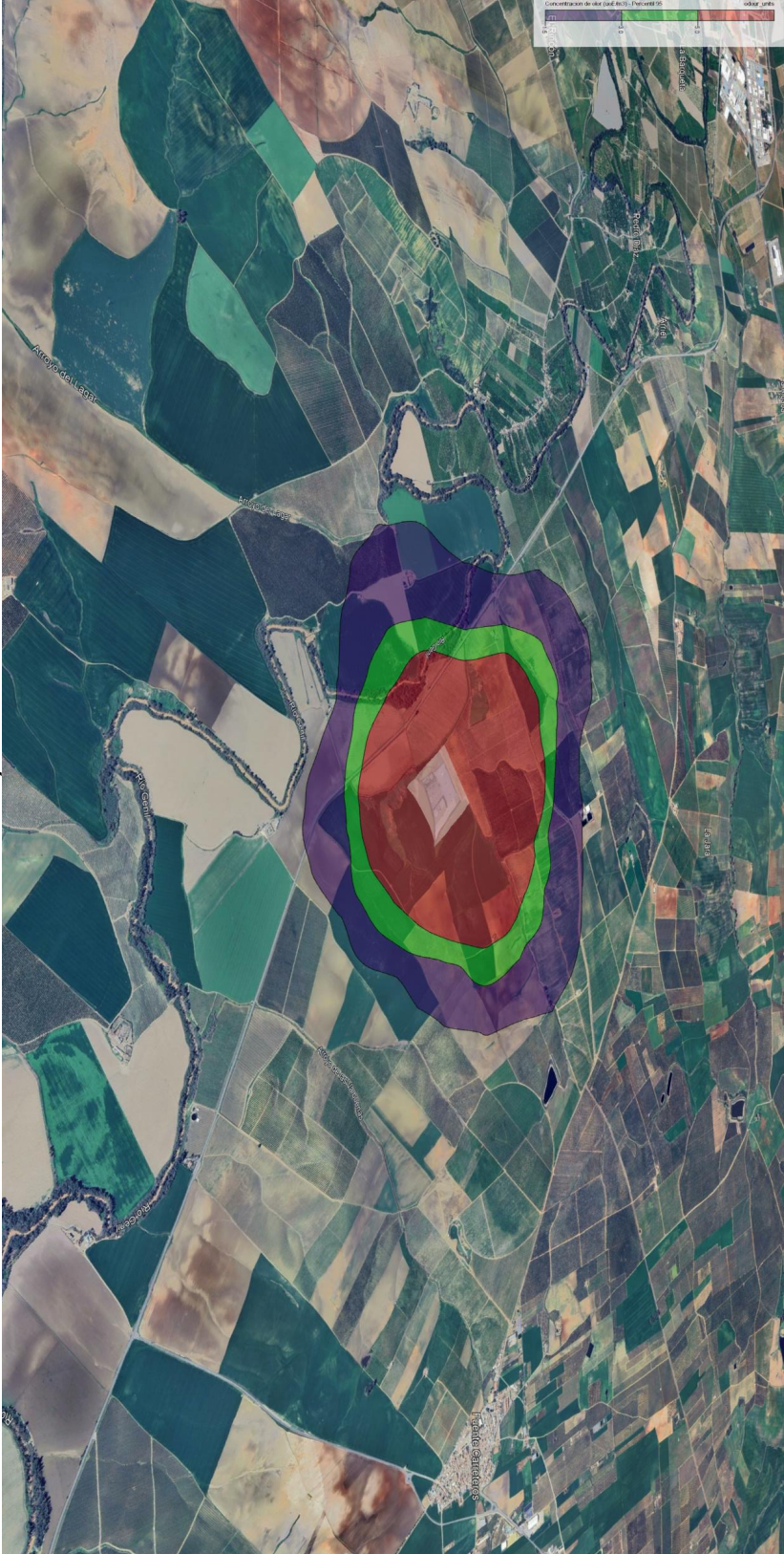
Figura IV.2. Modelización de la futura planta de producción de biogás de Écija (Sevilla). Isodoras 1,5, 3 y 5 uoE/m³ percentil 95 . Representación sobre ortofotografía 3D.
