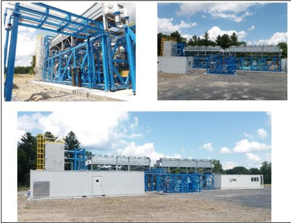
Ilustración 46. Ejemplo de equipo modular de licuefacción de metano.
