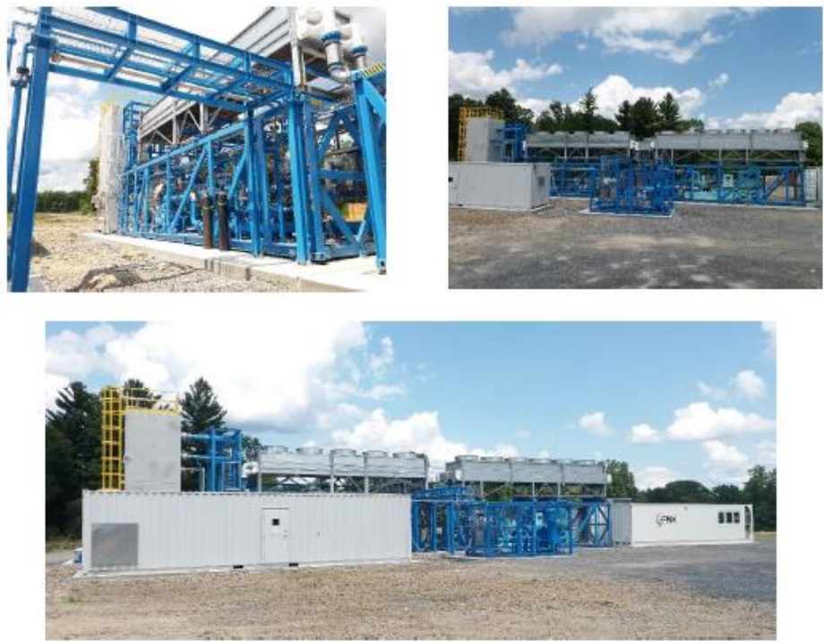
Figura 24: Ejemplo de equipo modular de licuefacción de metano.
