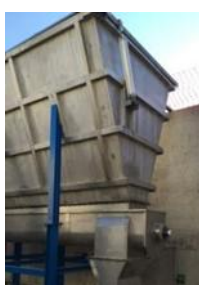
Ilustración 12. Tolva de recepción estanca para SANDACH y pretriturador de alta resistencia para materiales voluminosos con partes duras.
