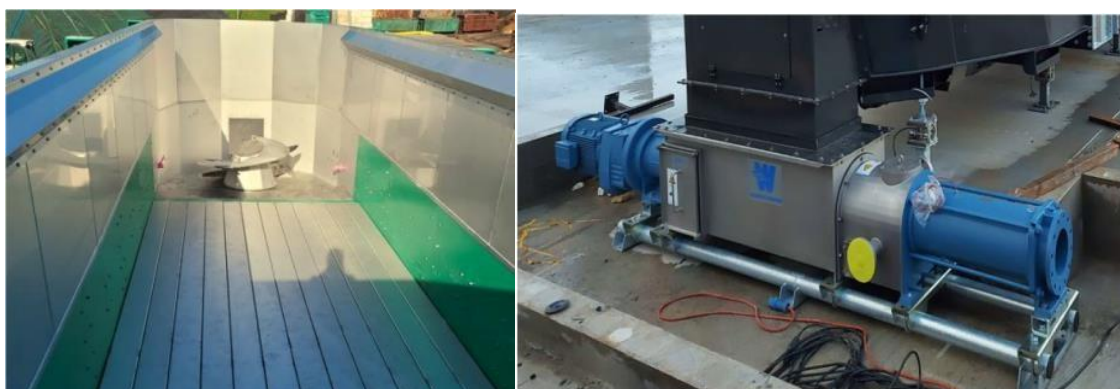
Ilustración 2. Unidad de alimentación de sólidos con suelo móvil. Exterior. Interior. Bomba de mezcla sólido-líquido.
