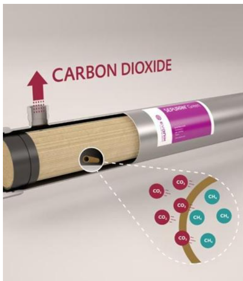
Ilustración 6. Principio de separación de membranas.
