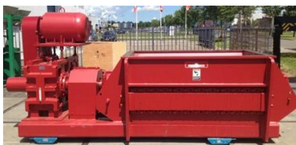
Ilustración 12. Tolva de recepción estanca para SANDACH y pretriturador de alta resistencia para materiales voluminosos con partes duras.
