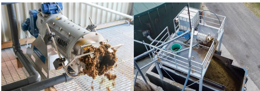
Ilustración 16. Primera etapa de deshidratación. Prensa tornillo.
