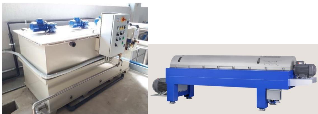
Ilustración 17. Segunda etapa de deshidratación. Equipo de preparación y dosificación de polielectrolito diluido. Centrífuga.
