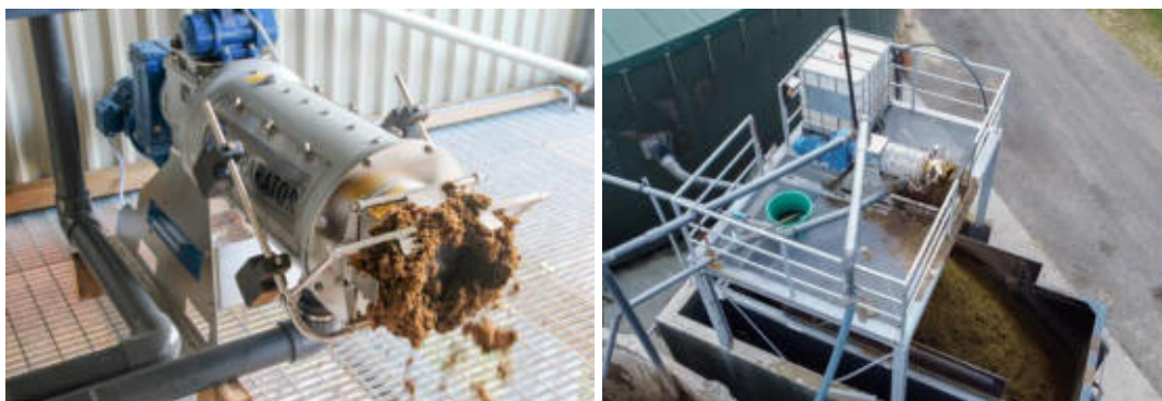
Ilustración 28. Primera etapa de deshidratación. Prensa tornillo.
