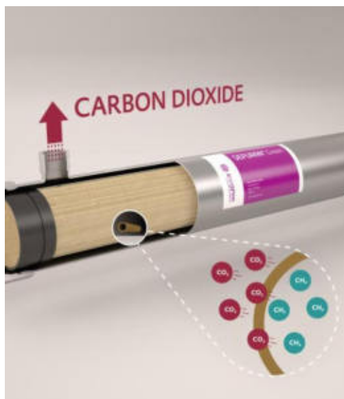
Ilustración 18.Principio de separación de membranas.
