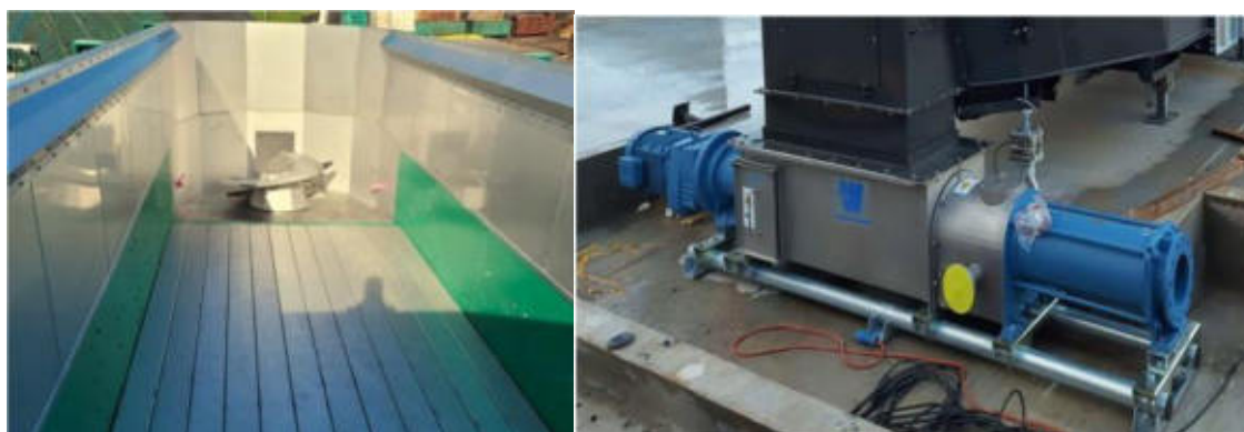
Ilustración 14. Unidad de alimentación de sólidos con suelo móvil. Exterior. Interior. Bomba de mezcla sólido-líquido.
