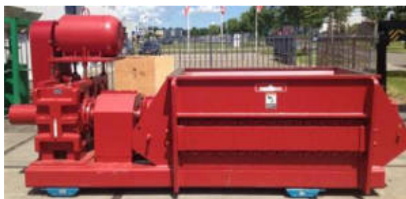
Ilustración 24. Tola de recepción estanca para SANDACH y pretriturador de alta resistencia para materiales voluminosos con partes duras.
