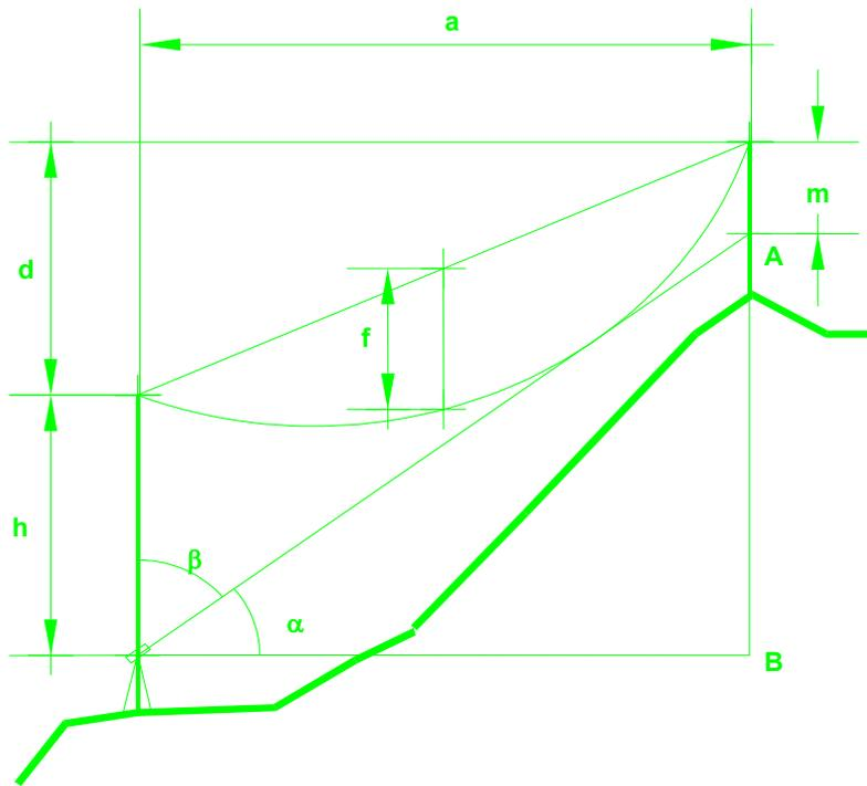
El ángulo  $\beta$  a marcar con taquímetros cuyo origen de ángulos, esté en la vertical ascendente será:
