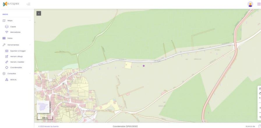
Y de este modo se han identificado las siguientes carreteras, caminos y viales del municipio de TORRE CARDELA en los que se efectuará tanto **despliegue aéreo** a través de postes telefónicos existentes como (**despliegue subterráneo a través de canalización existente**)
