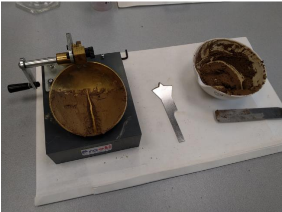
Fig 4 cuchara de Casagrande para determinar LL
