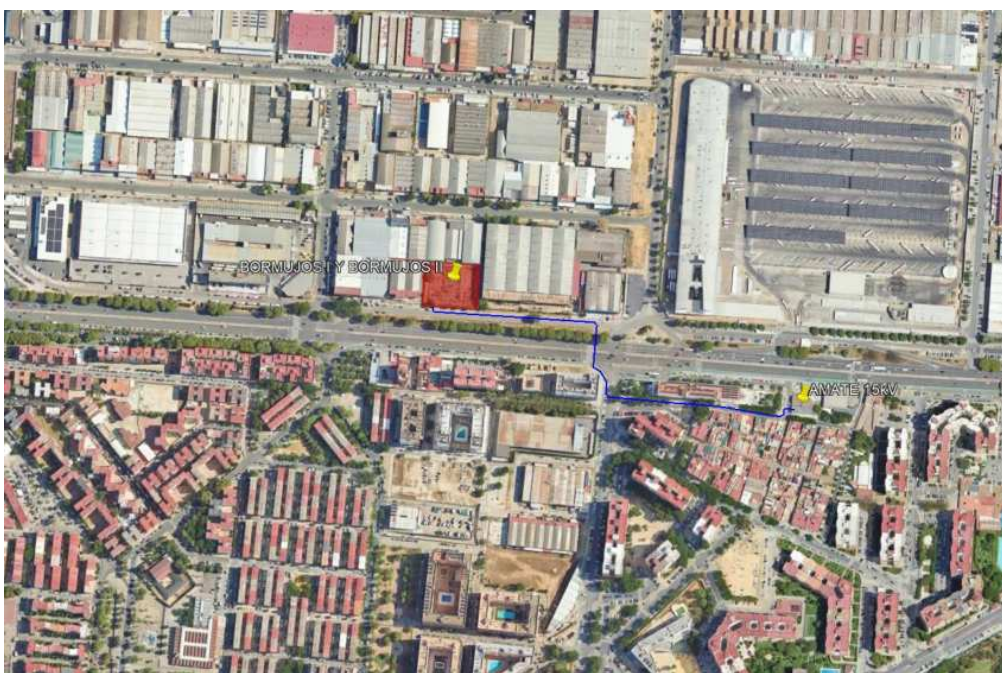
Ilustración 1: Recorrido del nuevo circuito, entre CT de los Sistemas de almacenamiento y el punto de conexión.
