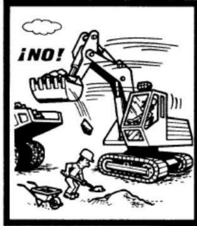
Permanecer fuera del radio de acción de la maquinaria de obra
