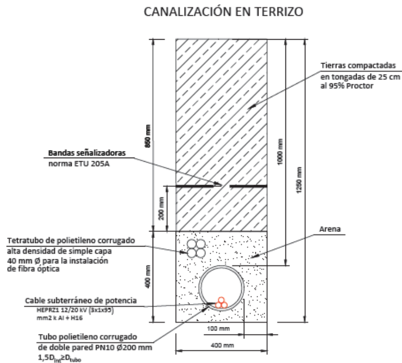
Ilustración 22. Zanja asociada al cable de 95mm 2
