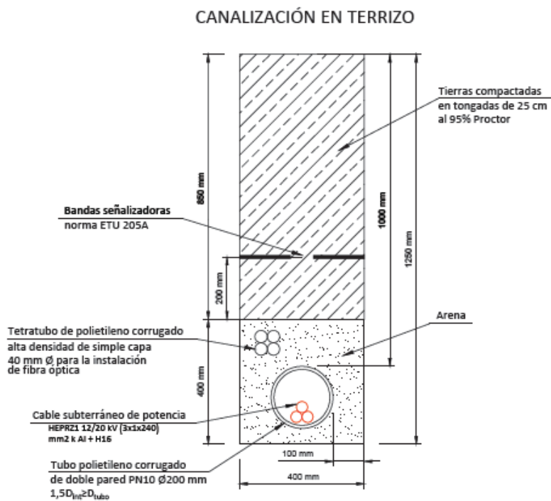
Ilustración 23. Zanja asociada al cable de 240mm 2
